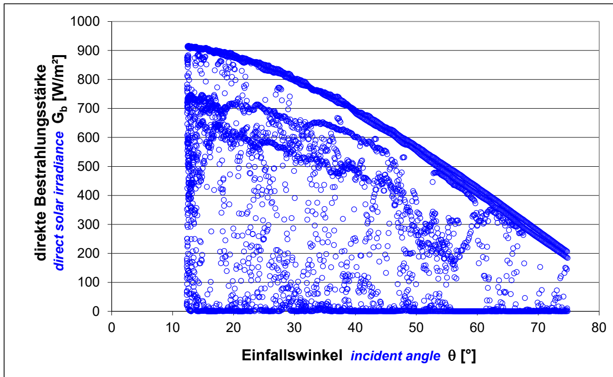
Abbildung A.1: Direkte Bestrahlungsstärke für unterschiedliche Einfallswinkel Figure A.1: Direct solar irradiance for different incident angles
